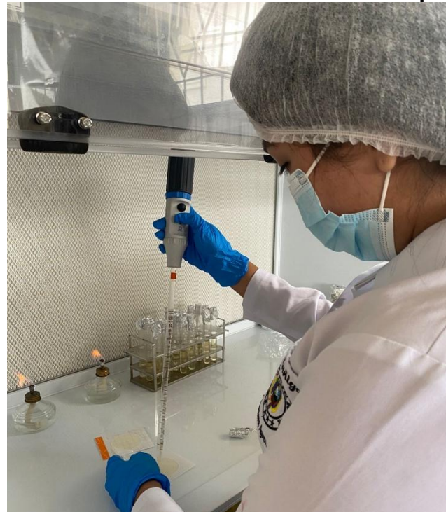
Figura 8. Siembra de las diluciones seriadas en las placas
