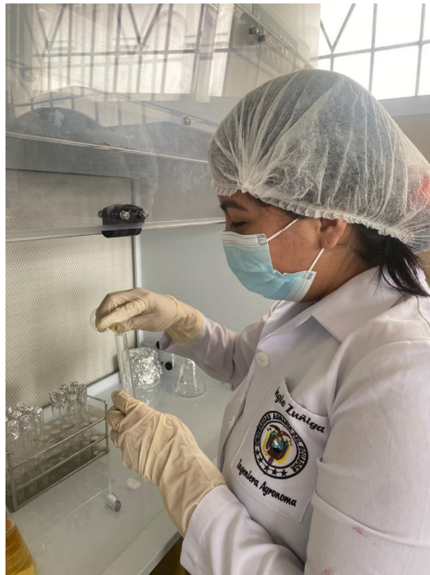
Figura 6. Preparación de las diluciones seriadas en los tubos de ensayo
